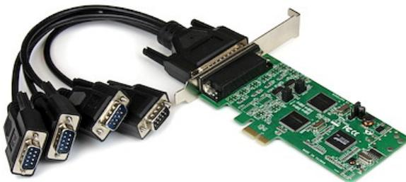
La carte combo série PCI Express 4 ports PEX4S232485 (2 RS232 2 RS422 / RS485) vous permet d'ajouter deux ports série RS232 et deux ports série RS422/485 à votre PC par le biais d'une fente d'extension PCI Express.
