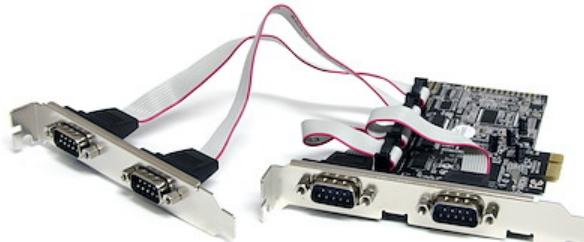
La Tarjeta Adaptadora PCI Express Serie RS232 Nativo de 4 Puertos con UART 16550, PEX4S553 permite agregar 4 puertos serie RS232 (DB9) a través de una única ranura de expansión PCI Express.
