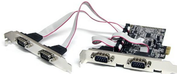
La Tarjeta Adaptadora PCI Express Serie RS232 Nativo de 4 Puertos con UART 16550, PEX4S553 permite agregar 4 puertos seriales RS232 (DB9) a través de una única ranura de expansión PCI Express.
