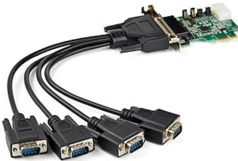
Esta tarjeta adaptadora serie RS232 PCI Express le permite añadir cuatro puertos serie RS232 (DB9) a su ordenador a través de una ranura PCI Express (PCIe). La tarjeta serie PCIe de 4 puertos le permite interactuar con dispositivos serie, como lectores de tarjetas, impresoras, PIN pads y módems, a velocidades de hasta 921,6Kbps.
