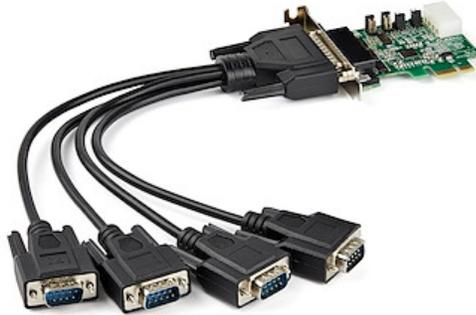
Con questa scheda adattatore seriale PCI Express RS232 è possibile aggiungere quattro porte seriali RS232 (DB9) a un computer tramite uno slot PCI Express (PCIe), consentendo l'interazione con dispositivi seriali come lettori per schede, stampanti, tastierini PIN e modem, a velocità fino a 921,6 Kbps.
