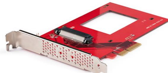
Fügen Sie ein 2,5 Zoll U.3 NVMe SSD mit den mitgelieferten Schrauben in einen PCIe 4.0 x4/x8/x16 Slot in einem Desktop oder Server ein und ermöglichen Sie so ultraschnellen Datenzugriff.
