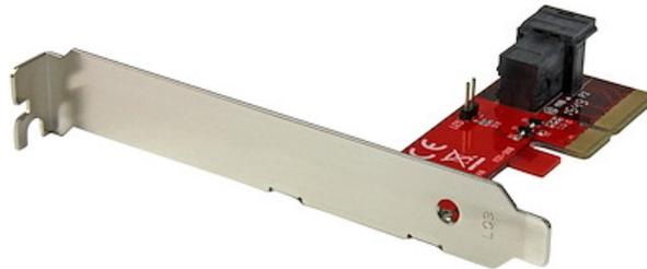
L'adattatore per dischi rigidi di livello enterprise consente di sfruttare al massimo le prestazioni di PC o server. La compatibilità con gli SSD U.2 NVMe di nuova generazione (es. SSD Intel® serie 750) garantisce velocità di lettura/scrittura superiori e produttività superiore per le applicazioni esigenti in termini di dati.
