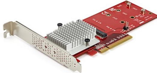
Grazie a questo adattatore è possibile aumentare la velocità e le prestazioni del sistema aggiungendo due unità SSD PCIe 3.0 M.2 (NVMe e AHCI) di classe enterprise a elevate prestazioni nello slot PCIe a 8 linee o più della workstation desktop o del server.
