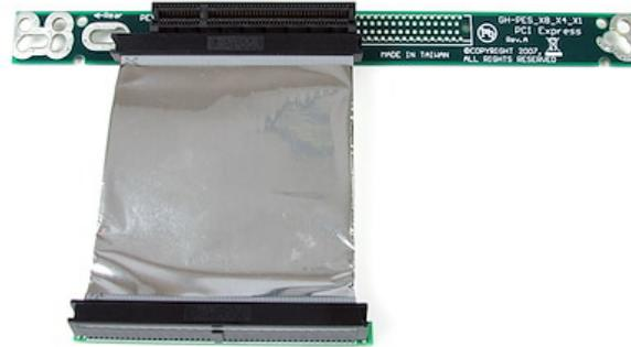
La carte riser PCI Express x8 vers x8 avec câble souple PEX8RISERF permet l'installation d'une carte PCI Express (PCI-E) x8/x4/x1 dans un châssis monté en rack 1U ou un châssis compact qui n'offre pas de montage direct des cartes sur la carte mère. Bénéficie de la garantie StarTech.com de 2 ans et de l'assistance technique à vie gratuite.
