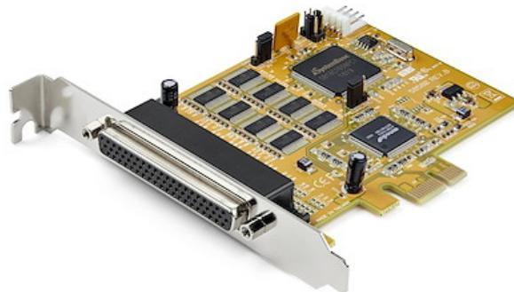
Fügen Sie Ihrem Desktop-Computer acht serielle RS-232 DB9-Ports über einen PCIe-Erweiterungskartensteckplatz hinzu. Diese PCI-Express serielle Karte mit 8-Port-Breakout-Kabel bietet Ihnen mehrere Ports zum Anschluss einer Vielzahl von seriellen Peripheriegeräten mit Geschwindigkeiten von bis zu 921,4Kbit/s.
