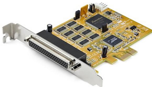
Añada ocho puertos serie RS-232 DB9 a su ordenador de sobremesa, a través de una ranura para tarjetas de expansión PCIe. Esta tarjeta serie PCI express, con cable multiconector de 8 puertos, le proporciona múltiples puertos para conectar una amplia variedad de periféricos serie, a velocidades de hasta 921,4Kbps.
