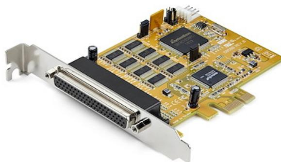
Ajoutez huit ports série RS-232 DB9 à votre ordinateur de bureau via des emplacements d'extension PCIe. Cette carte série PCI express, avec câble breakout à 8 ports, vous offre plusieurs ports pour connecter une grande variété de périphériques série, à des vitesses allant jusqu'à 921,4 Kbps.
