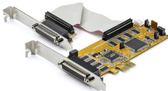
Agregue ocho puertos serie RS-232 DB9 a su computadora, a través de dos ranuras de una tarjeta de expansión PCIe. Esta tarjeta PCI Express con puerto serie y dos cables multiconectores, le ofrece varias opciones (puertos) para conectar diversos dispositivos serie, a velocidades de hasta 921.4Kbps.
