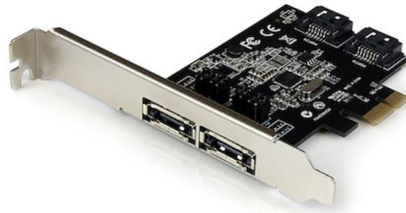
Mit der PCI Express SATA III Controller-Karte (6 Gbit/s) PEXESAT322I können Sie Ihrem Computer über einen einzigen PCI Express-Kartensteckplatz (x1) 2 interne oder externe SATA-Ports hinzufügen. Die Karte verfügt über eine Steckbrückenauswahl, mit deren Hilfe Sie die Karte für 2 interne oder externe SATA III-Ports oder je einen internen und einen externen Port konfigurieren können.
