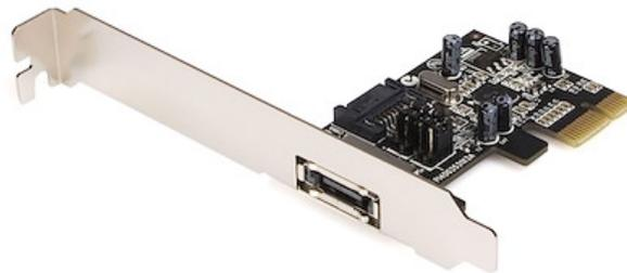
Esta Tarjeta Controladora eSATA convierte una ranura PCI Express (1x) en un puerto SATA externo brindando una solución de almacenamiento externo rápida y simple.
