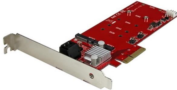
Questa scheda controller RAID SSD M.2 consente di installare due unità M.2 NGFF (Next Generation Form Factor) nel computer desktop. La scheda è dotata anche di due porte SATA III (6 Gbps) e supporta RAID hardware. Ora è possibile unire la velocità e le dimensioni compatte delle unità a stato solido (SSD) M.2 alla capacità di archiviazione degli hard disk (HDD) tradizionali.
