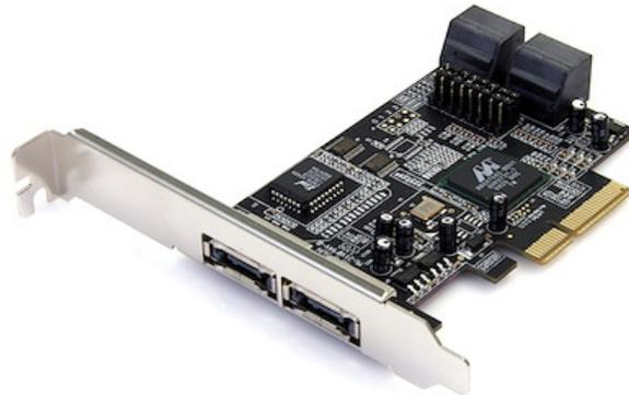
Cette carte contrôleur PCIe eSATA/SATA permet d'ajouter deux ports externes ATA série (eSATA) et quatre ports SATA internes, permettant aux utilisateurs d'exploiter la vitesse et la fiabilité des connexions de disque ATA série.
