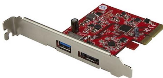
Esta tarjeta controladora PCI Express de combinación le permite agregar un puerto USB 3.2 Gen 2 y un puerto eSATA a su computador de escritorio, a través de una sola ranura PCIe. La tarjeta controladora versátil ofrece una forma rentable de agregar conectividad de alto rendimiento a su computador, con compatibilidad para dispositivos USB 3.2 Gen 2 más nuevos, así como también discos duros eSATA.
