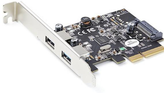
Esta tarjeta controladora PCIe USB 3.2 Gen 2 se instala en una ranura PCI-Express x4 disponible de su ordenador y le permite actualizar su sistema existente agregando dos puertos SuperSpeed USB-A (10Gbps).
