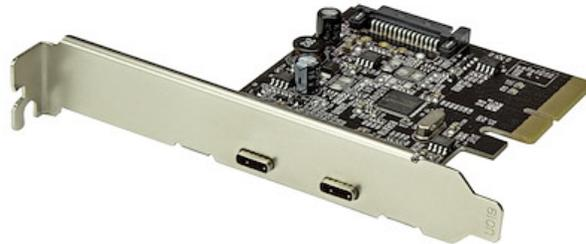
Con questa scheda USB 3.1 è possibile aggiungere due porte USB-C™ al computer tramite uno slot PCI Express. Consente di aggiornare il sistema corrente grazie all'aggiunta di due porte USB 3.1 Gen 2 al computer e alla possibilità di utilizzare velocità di trasferimento dati fino a 10 Gbps.
