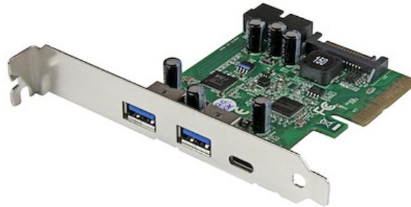
5ポートUSB 3.1コンボカード。コンピュータの性能と接続機能を増強できる手軽なソリューションです。USB Type-C™ポート(10Gbps)、一般的なUSB Type-Aポート(5Gbps)、マザーボードヘッダを増設できる市場でも稀なUSB 3.1カードです。
