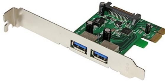
La carte PCI Express USB 3.2 Gen 1 2 ports PEXUSB3S24 vous permet d'ajouter deux ports USB 3.2 Gen 1 à tout système informatique compatible PCI Express, avec un connecteur d'alimentation SATA optionnel à brancher sur l'alimentation de votre système afin d'obtenir jusqu'à 900 mA par port pour les périphériques alimentés par bus USB 3.2 Gen 1 (500 mA pour l'USB 2.0).
