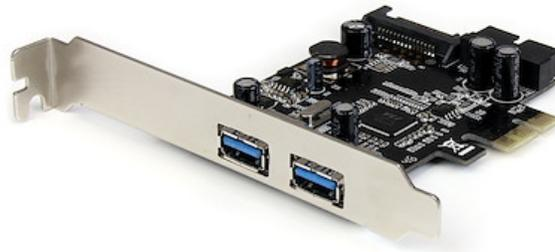
La scheda controller USB 3.0 PCI Express a 4 porte PEXUSB3S2E2I permette di aggiungere 2 porte USB 3.0 esterne e 2 collettori scheda madre USB 3.0 interni a un sistema di computer dotato di PCI Express con il supporto di velocità di trasferimento dati USB 3.0 SuperSpeed fino a 5Gbps ed è inoltre compatibile all'indietro con dispositivi basati sugli standard USB precedenti (USB 2.0, 1.x).
