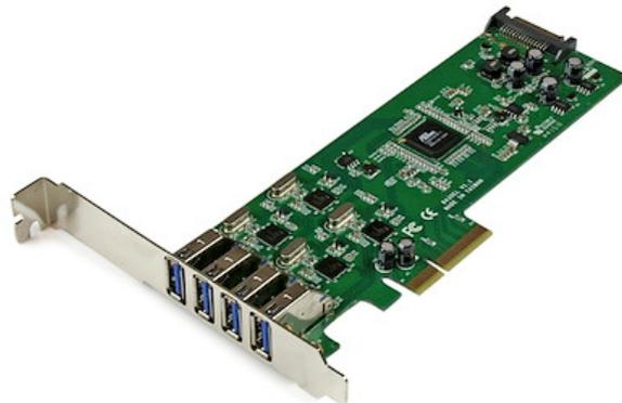
La carte PCI Express USB 3.0 PEXUSB3S400 ajoute 4 ports USB 3.0 externes à tout ordinateur compatible PCI Express x4, avec la prise en charge d'une pleine vitesse de transfert (jusqu'à 5 Gb/s) par port lorsqu'elle est connectée à des périphériques USB 3.0. Contrairement aux autres cartes USB 3.0 qui divisent le débit maximal entre les nombreux ports, la PEXUSB3S400 offre une vitesse de transfert maximale à chacun des appareils connectés.
