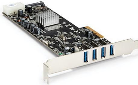
Mit der 4-Port-PCI Express-USB 3.2 Gen 1-Karte PEXUSB3S44V können Sie einem PCIe x4-fähigen PC vier dedizierte 5-Gbit/s-USB 3.2 Gen 1-Ports hinzufügen. Diese Architektur mit unabhängigen Ports verbessert die USB 3.2 Gen 1-Leistung durch Übertragen von Daten auf vier einzelnen Kanälen an den Computer, sodass die Dateiübertragung schneller erfolgt.
