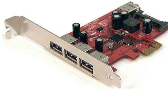
La scheda PCI Express SuperSpeed USB 3.0 a 4 porte (con alimentazione SATA) PEXUSB3S4 consente di aggiungere 3 porte USB 3.0 esterne e una interna a qualsiasi computer dotato di PCI Express. Grazie a SuperSpeed USB 3.0, è possibile raggiungere velocità di trasferimento dei dati fino a 5 Gbps conservando la compatibilità all'indietro con i dispositivi USB 2.0 esistenti a una velocità di 480 Mbps.
