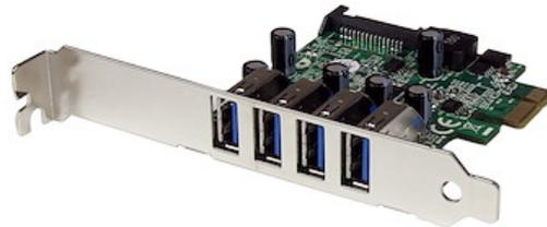
PCI Express 対応PCにUSB 3.2 Gen 1ポート4口を増設するインターフェースカード。USB 2.0 / 1.xデバイスとも下位互換性を維持しながら、5Gbps対応の高速データ転送に対応します。
