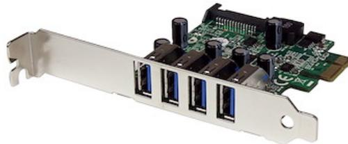
La tarjeta PCI Express USB 3.2 Gen 1 (con alimentación SATA), modelo PEXUSB3S4V, permite agregar 4 puertos USB 3.2 Gen 1 externos a cualquier sistema informático equipado con PCI Express, además de admitir tasas de transferencia de datos de hasta 5 Gbps y ser retrocompatible con dispositivos USB 2.0 / 1.x.
