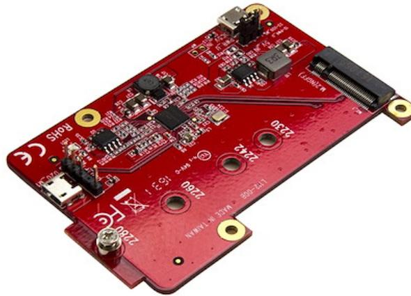
Erhöhen Sie die Datenspeicherkapazität Ihrer Raspberry Pi oder einer anderen Entwicklungsschnittstelle, indem Sie sie direkt an eine M.2 NGFF SATA-SSD anschließen. Dieser USB-zu-M.2 SATA-Konverter ist perfekt für maßgeschneiderte Projekte und Anwendungen geeignet und unterstützt alle Raspberry Pi-Modelle sowie weitere Entwicklungsschnittstellen.
