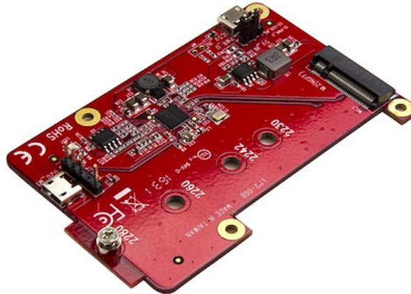
Aumente la capacidad de almacenamiento de datos de su Raspberry Pi o cualquier otra placa de desarrollo, mediante la conexión directa de la placa a una unidad SSD M.2 SATA NGFF. Solución perfecta para proyectos y aplicaciones personalizados, este convertor USB a M.2 SATA es compatible con todos los modelos de Raspberry Pi, así como otras placas de desarrollo.
