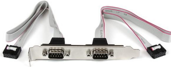
La Placa Serie de Dos Puertos, PLATE9M2P16 permite agregar dos puertos serie DB9 al panel trasero de un ordenador mediante una conexión a dos conectores de cabezal IDC10 de la placa base.
