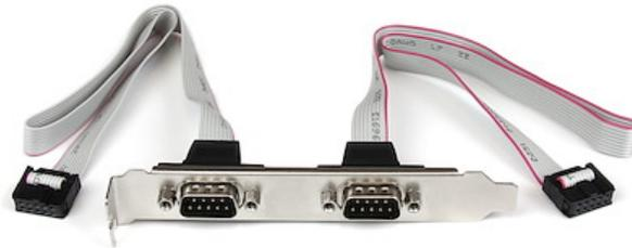
La piastra seriale a due porte PLATE9M2P16 permette di aggiungere due porte seriali DB9 al pannello posteriore del computer, consentendo il collegamento a due connettori per collettori IDC10 sulla scheda madre.
