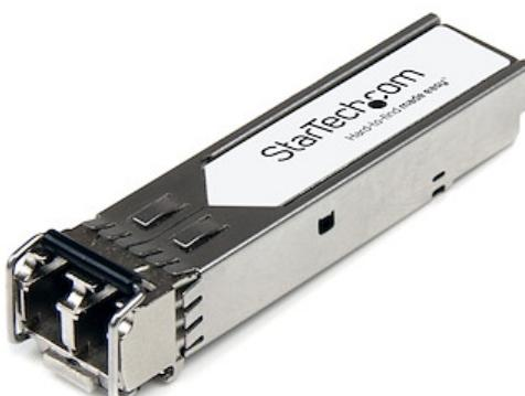
El PLUS-SR-ST es un módulo transceptor de fibra compatible con PAN-SFP-PLUS-SR de Palo Alto Networks que ha sido diseñado, programado y probado para funcionar con conmutadores y enrutadores de la marca Palo Alto Networks. Proporciona una conectividad fiable de 10 GbE a través de cable de fibra, para redes compatibles con 10GBASE-SR, con una distancia máxima de hasta 300 m (984 pies).
