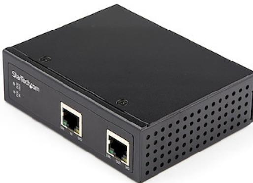
Étend la portée des liaisons PoE jusqu'à 100 m pour alimenter des périphériques sur de longues distances ; il est possible d'installer jusqu'à 4 répéteurs en cascade pour étendre la portée d'un périphérique source PoE (PSE) jusqu'à 400 m supplémentaires, pour une portée totale de 500 m de la source PSE d'origine au périphérique cible.
