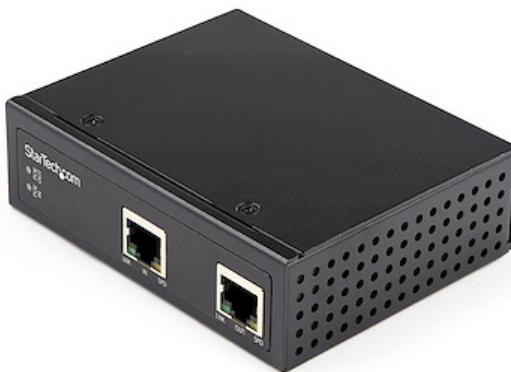
Consente di estendere la portata dei collegamenti PoE fino a 100 m per alimentare dispositivi PD (Powered Device) su lunghe distanze. È possibile collegare a cascata fino a 4 extender per estendere la portata di un dispositivo PSE (sorgente PoE) fino a ulteriori 400 m, per una portata totale di 500 m tra la sorgente PSE originale e il dispositivo di destinazione.
