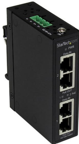
Der industrielle 2-Port-Gigabit-PoE+-Injektor POEINJ2GI bietet Strom- und Datenverbindung mit bis zu zwei Gigabit PoE-konformen Geräten über standardmäßige Ethernetkabel in Entfernungen von bis zu 100 m. Dieser Dual-Port-PoE-Injektor ermöglicht das einfache Anschließen von zwei PoE-betriebenen Geräten (PD) an einen Nicht-PoE-LAN-Switch, sodass die Kosten für das Aufrüsten des Switches auf ein PoE-fähiges Modell unnötig ist.
