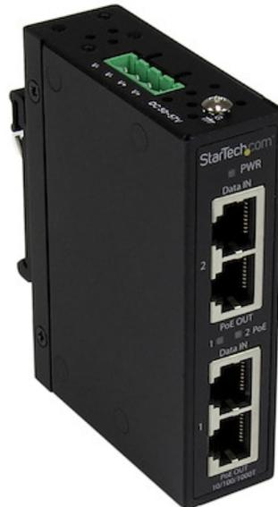
L'injecteur PoE+ Gigabit industriel 2 ports POEINJ2GI peut fournir une alimentation et une connectivité de données à deux appareils PoE Gigabit sur câblage Ethernet standard, sur des distances pouvant atteindre 100 m. Cet injecteur PoE à deux ports vous permet de connecter facilement deux périphériques alimentés par PoE à un commutateur LAN non PoE, vous évitant ainsi le coût lié à l'achat d'un commutateur compatible PoE.
