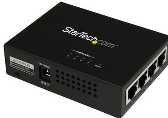
Cet injecteur Midspan PoE+ Gigabit constitue une alternative économique à la mise à niveau de votre commutateur de réseau en modèle compatible PoE.
