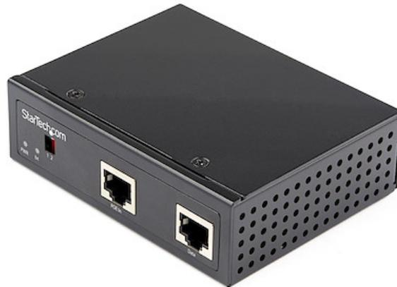
Teilt eine PoE-Verbindung (max. 90 W) in einen Datenstrom (RJ45) und eine Gleichstromversorgung (Klemmleiste) auf, die jedes Gerät mit Gleichstrom zwischen 12 V und 48 V DC (1,5 A) versorgen kann. Versorgen Sie nicht PoE-fähige Geräte über die Netzwerkinfrastruktur, wenn keine Stromversorgung verfügbar ist.
