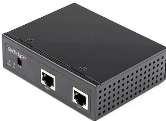
Multiplica una conexión PoE (90W máximo) en datos separados (RJ45) y alimentación CC (bloque de terminales), lo cual permite la alimentación de cualquier dispositivo que utilice alimentación CC entre 12V a 48V CC (1,5A). Alimente dispositivos que no utilizan alimentación PoE mediante la infraestructura de red, cuando no hay alimentación disponible.
