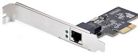
Cette carte d'interface réseau (NIC) 2,5 GbE est équipée d'une puce Intel I225-V avec la technologie Intel vPro, pour améliorer les performances et l'intégrité des données. Des options de vitesse multiples (2,5/1 Gbit/s et 100/10 Mbit/s) permettent la prise en charge à la fois du matériel réseau récent et ancien. Exploitez l'infrastructure de câblage existante Cat5e ou CAT6 tout en ajoutant la compatibilité NBASE-T (802.3bz) pour une intégration transparente.
