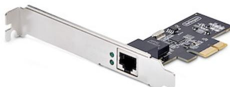
Questa scheda di interfaccia di rete (NIC) da 2,5 GbE è dotata di un chipset Intel I225-V con tecnologia Intel vPro, per migliorare le prestazioni e l'integrità dei dati. Le opzioni multispeed variabili (2,5/1GbE e 100/10Mbps) consentono di supportare sia l'hardware di rete nuovo che quello preesistente. Sfrutta l'infrastruttura di cablaggio Cat5e o CAT6 esistente, aggiungendo la compatibilità NBASE-T (802.3bz) per una perfetta integrazione.
