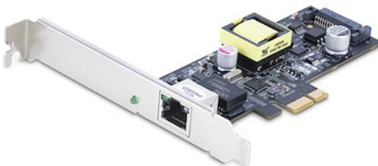
Questa scheda di interfaccia di rete (NIC) da 2,5 GbE è dotata di un chipset Intel I225-V con tecnologia Intel vPro, per migliorare le prestazioni e l'integrità dei dati. Le opzioni multispeed variabili (2,5/1Gbps e 100/10Mbps) consentono di supportare sia l'hardware di rete di nuova generazione che quello precedente. Utilizza l'infrastruttura di cablaggio Cat5e o CAT6 esistente, aggiungendo la compatibilità NBASE-T (802.3bz) per un'integrazione perfetta.
