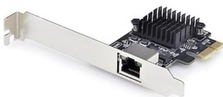
Esta tarjeta Gigabit Ethernet 5G conforme a la TAA con chip Realtek RTL8126 añade una interfaz Gigabit Ethernet a un ordenador de sobremesa o servidor. Las velocidades 2,5G y 5G maximizan la infraestructura Cat5e, proporcionando un rendimiento multi-Gig sin necesidad de actualizar el cableado.
