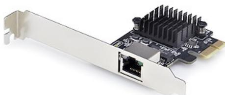
Questa scheda Ethernet 5G Gigabit con chip Realtek RTL8126 conforme TAA, consente di aggiungere una porta LAN a un computer desktop o a un server. Le velocità 2.5G e 5G permettono di sfruttare al massimo l'infrastruttura in Cat5e, con prestazioni multi-Gigabit senza la necessità di dover aggiornare il cablaggio.
