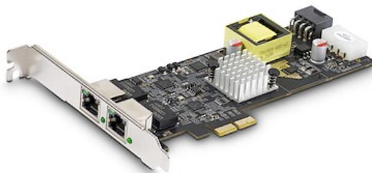
Cette carte d'interface réseau (NIC) 2,5 GbE est équipée de deux chipsets Intel I225-V avec la technologie Intel vPro pour améliorer les performances et l'intégrité des données. Les options multi-vitesse variables (2,5/1 Gbps et 100/10 Mbps) permettent la prise en charge des matériels réseau récents et anciens. Utilisez l'infrastructure de câblage existante en CAT5e ou CAT6 tout en ajoutant la compatibilité NBASE-T (802.3bz) pour une intégration transparente.
