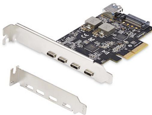
Actualice o amplíe la conectividad USB de un equipo de sobremesa o servidor añadiendo cuatro puertos USB externos Tipo-C a 10 Gbps y un puerto USB interno Tipo-A a 10 Gbps a través de una única conexión PCI Express x4.
