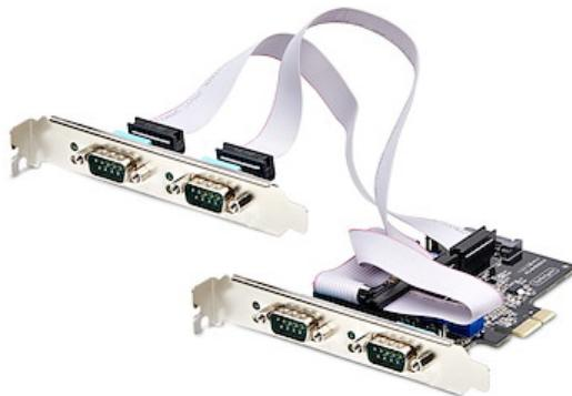
Erweitern Sie Ihren Desktop-Computer oder Ihr Small Form Factor (SFF)-System mit dieser seriellen PCI-Express-Karte mit 4 Ports um serielle Kommunikationsunterstützung. Die vier DB9-Anschlüsse können unabhängig voneinander zur Unterstützung der Standards RS-232, RS-422 und 2/4-Draht RS-485 für die Kommunikation mit kompatiblen seriellen Peripheriegeräten konfiguriert werden..
