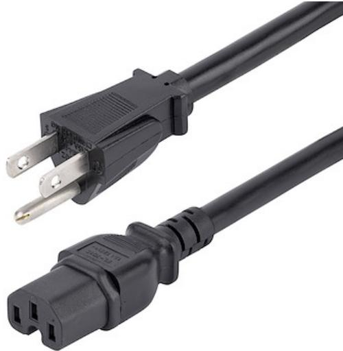
El Cable de Alimentación de PC modelo PXT515C158 de 2.4m de longitud, dispone de un conector C15 clasificado para equipos de alta temperatura, así como un calibre de 14AWG adecuado para conexiones de alta potencia - una solución confiable para la conexión a NEMA unidades de distribución de energía 5-15P (PDU) ubicados en salas de equipos de conmutación y entornos de centros de datos o aplicaciones de servidores de gran tamaño que requieren un cable de mayor calibre con mayor capacidad.
