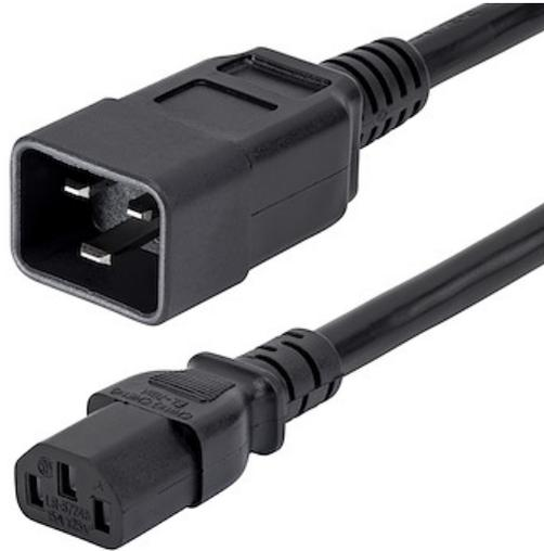
Dieses C13-auf-C20-Netzkabel von StarTech.com verfügt über ein 2,5 mm<sup>2</sup>-Kabel, das für leistungsfähige Verbindungen geeignet ist. Damit ist es hervorragend für Serveranwendungen und zum Anschließen an einen Stromverteiler (PDU - Power Distribution Unit) geeignet.
